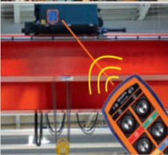
**Radiomatic Infrakey® (opcional)**, uma conexão infravermelha entre o transmissor e o receptor é necessária para ligar o sistema. O que protege o operador contra acidentes ocasionados por movimentos involuntários.
