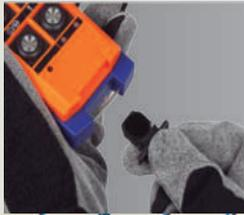
**Radiomatic iLog**, que permite a ativação rápida de um transmissor reserva caso o transmissor original esteja danificado, o que evita período de inatividade.
