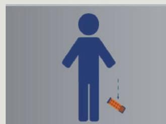
**Funções de segurança HBC (opcionais)**, que em situações de emergência aciona o desligamento automático do controle através do radiomatic® Shock-Off / Roll-Detect / Zero-G / Inclinação;
