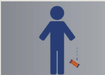
**Funções de segurança HBC (opcionais)**, que em situações de emergência aciona o desligamento automático do controle através do radiomatic® Shock-Off / Roll-Detect / Zero-G / Inclinômetro;
